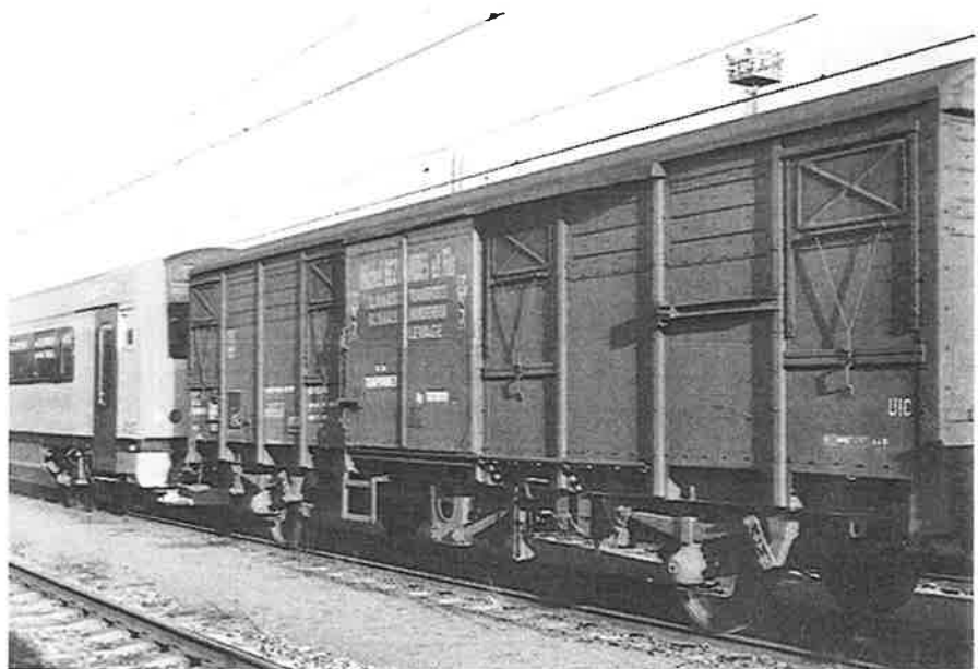
Een voormalige goederenwagen met smalprofiel voor het scheepstransport naar Engeland doet nu dienst als schut- en remwagen voor de dieselmotorwagens. Foto : Alain Janmart.
