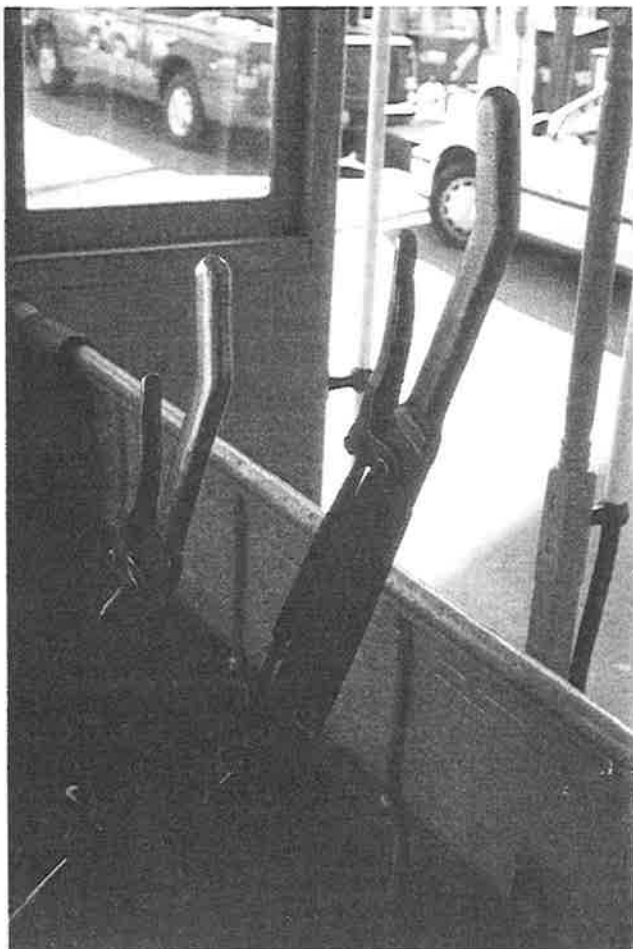
De twee voornaamste besturingshendels van een kabeltram: de kabelgrijper (links) en de rem. Veel meer hoeft dat niet te zijn... • De "gripman" gooit de rem los en wij zijn vertrokken voor de merkwaardigste tramrit van ons leven! Alle foto's, tenzij anders vermeld: Staf Cuyt, december 1998 en september 1999.
